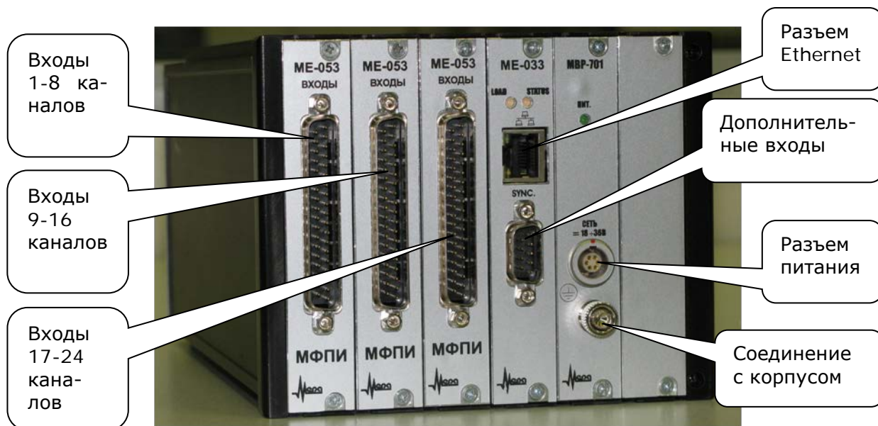
Рис. 1.2. Крейт MIC-1200. Расположение разъемов.
