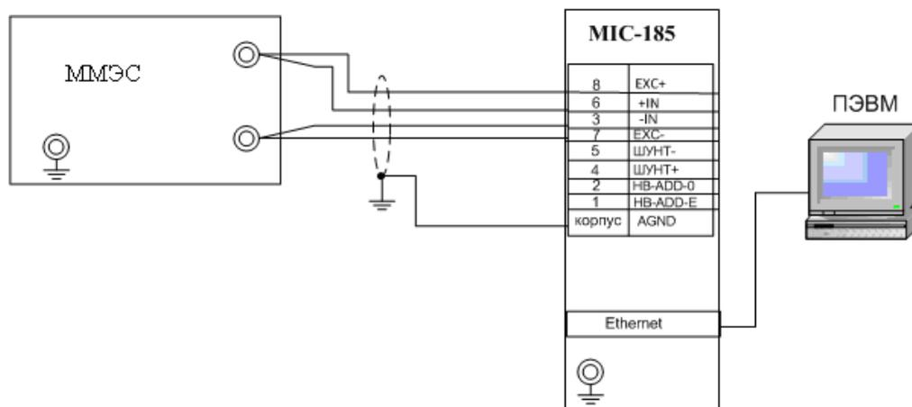
Рисунок 5 – Схема подключения для определения погрешности измерений сопротивления
