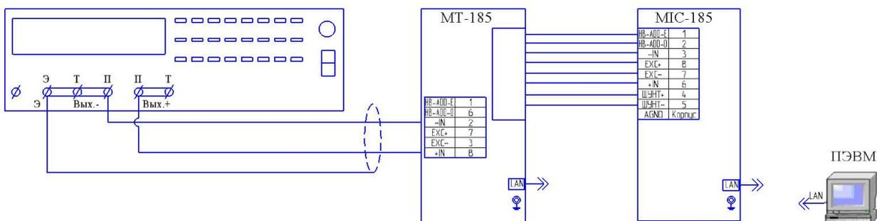
Рисунок 3а – Схема подключения для определения погрешности измерений напряжения постоянного тока при автоматизированной поверке с использованием коммутатора МТ-185.
