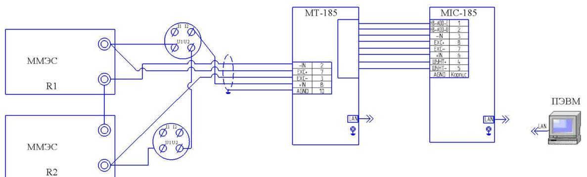
Рисунок 7а – Схема подключения для определения погрешности измерений при работе с мостовым тензодатчиком при автоматизированной поверке с использованием коммутатора МТ-185.
