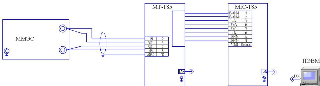
Рисунок 5а – Схема подключения для определения погрешности измерений сопротивления при автоматизированной проверке с использованием коммутатора МТ-185.
