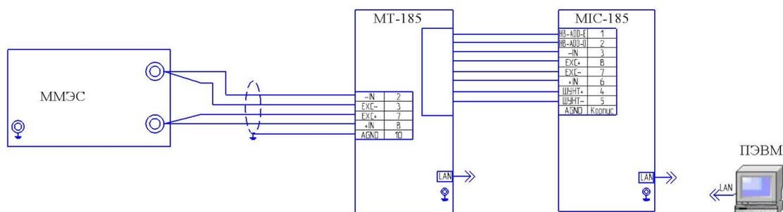
Рисунок 8а – Схема подключения для определения погрешности измерений температуры термопреобразователями сопротивления при автоматизированной поверке с использованием коммутатора МТ-185.
